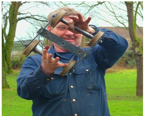
Bild 3 Crashtest für Drehgestelle: freier Fall aus 1m50 Höhe
