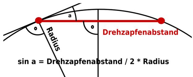
Bild 4 Die Auslenkung ist immer kleiner als 10°
