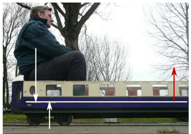
Bild 13 Dieser Fahrgast entlastet das vordere Drehgestell und bringt es zum Entgleisen
