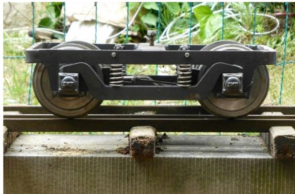
Bild 1: Pennsylvania-Drehgestell
