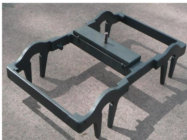
Bild 2: Rahmen eines Pennsylvania-Drehgestells
