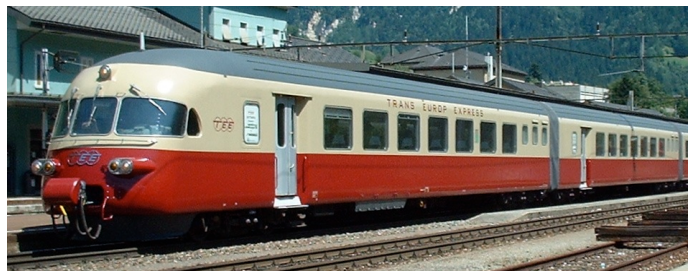
TEE 1958 in Airolo Kasten unten RAL3003, oben RAL1001, Dach RAL7001
