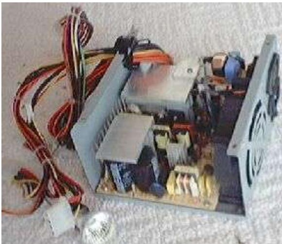
230 Watt ATX-Netzteil
